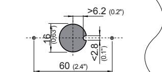
Durch die Ausformung einer positiven Kontur im Wanddurchbruch des Kanals kann die richtige Positionierung des Flansches zur Strömungsrichtung vorgegeben werden.
