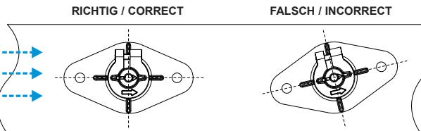
Mit dem Montageflansch kann die Eintauchtiefe stufenlos eingestellt werden. Es ist darauf zu achten, dass sich beide Sensoröffnungen im Luftstrom befinden!
