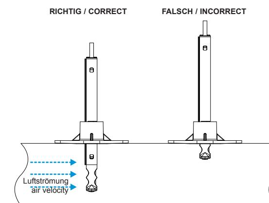
Bei der Montage des Fühlers ohne Montageflansch ist darauf zu achten, dass der Strömungssensor parallel zur Luftströmung ausgerichtet ist.
